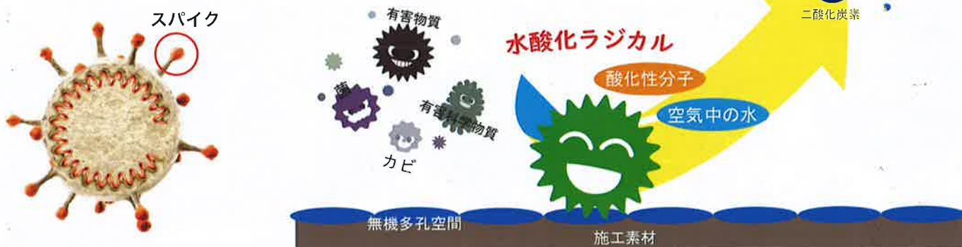
オールチタンコーティング分解原理イメージ
